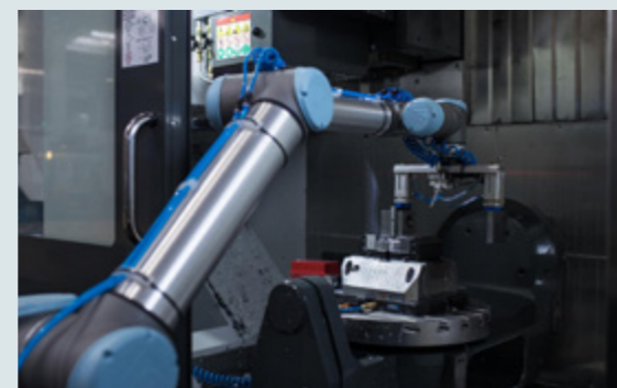
Abbildung 31: 14 UR10 am Werkstück Quelle: www.nc-fertigung.de/sinnvoll-und-effektiv-cobots-an-der-fraesmaschine
