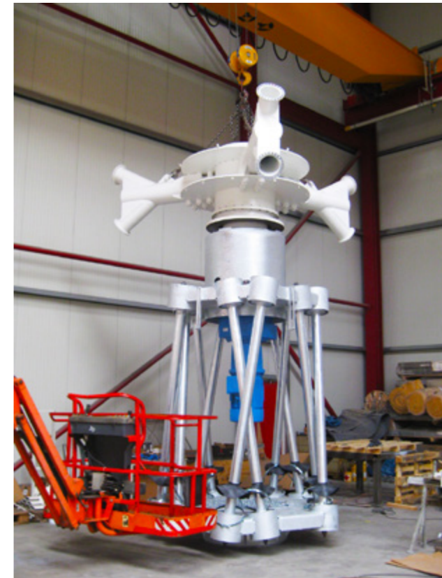
Abbildung 20: Prototyp des Schwingungsentkopplers (Foto: STM Montage)
